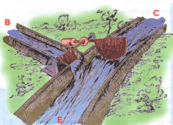
Figura 10.7a. Analogía de un canal de agua regulado con el transistor. En este caso no hay agua (corriente de base) en el canal regulador (B) y no hay paso de agua desde el punto C (colector) hacia el punto E (emisor).
